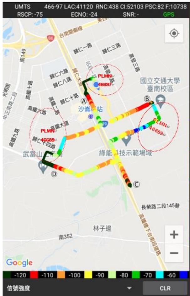
圖 2：電波涵蓋狀況之量測結果（原始畫面）
