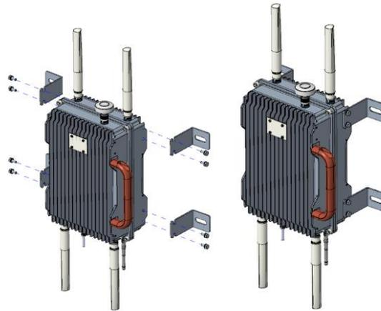
圖 12：壁掛支架安裝示意圖
