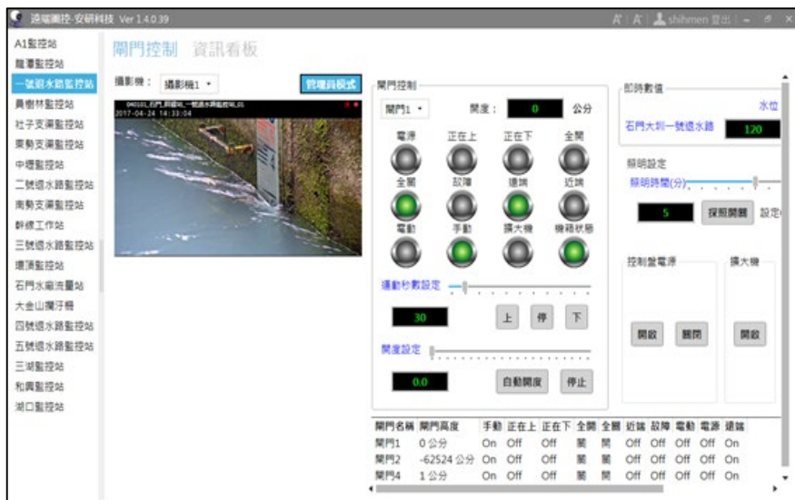
▲ 閘門圖控平台
